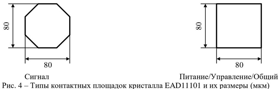
Рис. 4 – Типы контактных площадок кристалла EAD11101 и их размеры (мкм)
